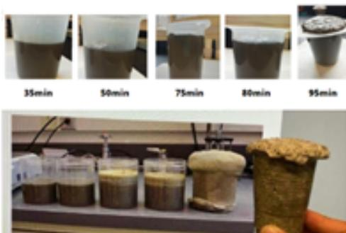
Se observa reacción química por combinación de cemento con MMRR, en margen de tiempo una vez pre mezclado y agregado la aceleración, duplicado parcial de un volumen lechada vs otro sistema cementante de polímeros minerales de amplia acción, certificando el funcionamiento de forma cualitativa de nuestro aditivo MMRR.
