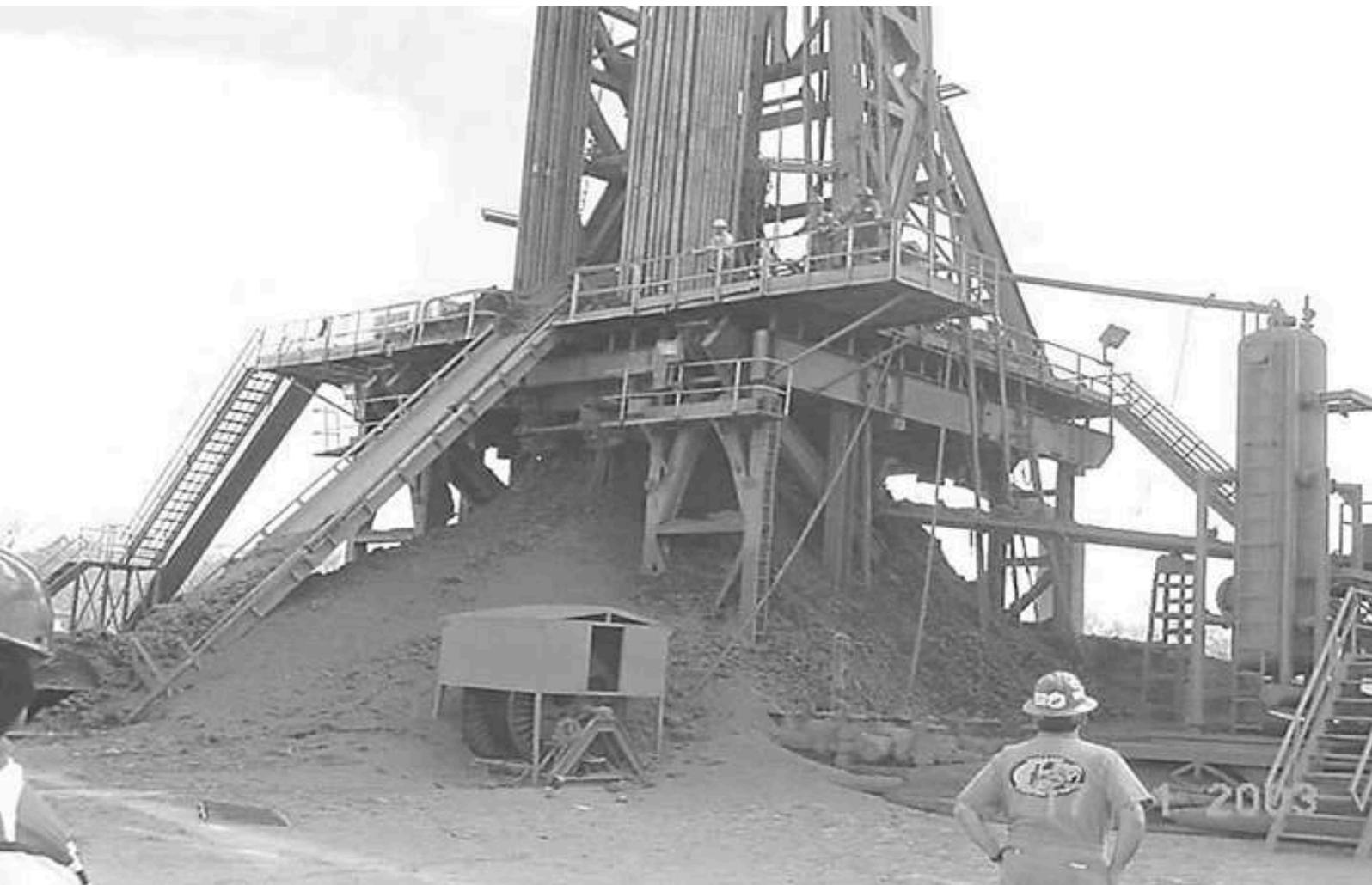
**Figura 3. Blow Out durante la perforación del hoyo intermedio. Campo San Joaquín.**
