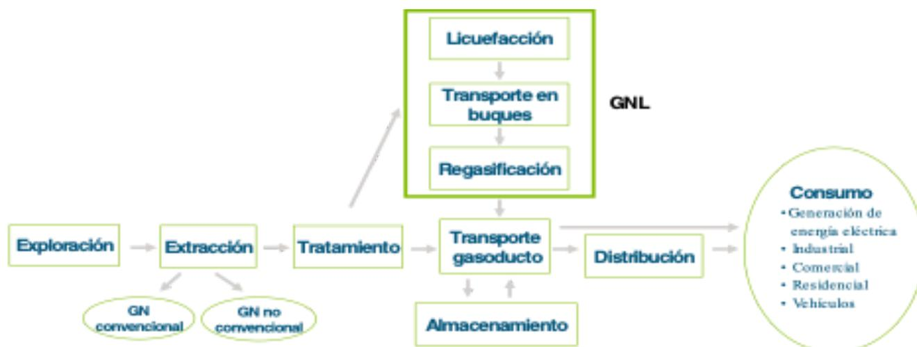
Figura 2. Subcadena de valor del hidrocarburo gaseoso o GN.
