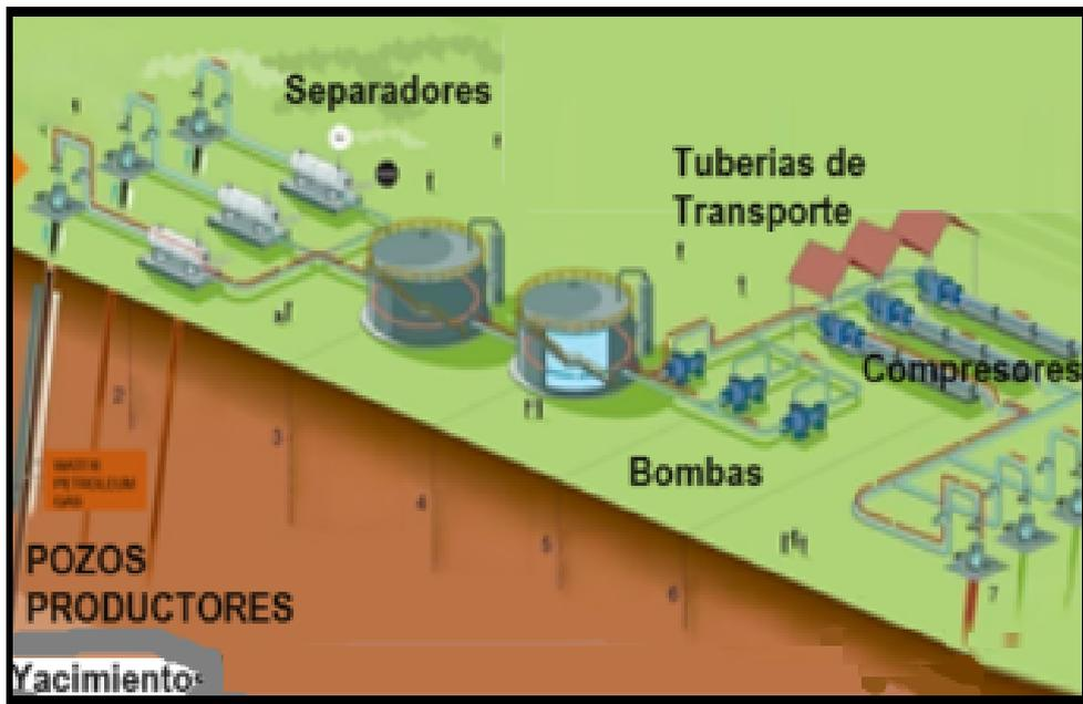
**Figura No. 2:** Planta de Producción de Hidrocarburos
